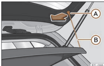
Billede 161 I bagagerummet: af- og påmontering af bagagerumsafdækning
