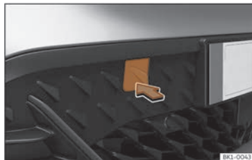
Billede 177 | Højre side af den forreste stødfanger: fjernelse af afdækning
