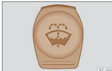
Billede 188 I frontrummet: blåt dæksel på sprinklervæskebeholderen
