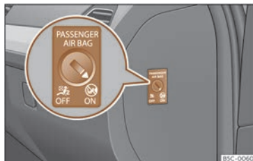
Billede 26 Nøglekontakt til til- og frakobling af forsædepassagerens frontairbag
