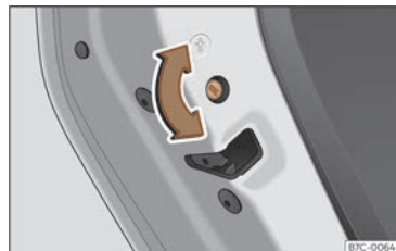
Billede 77 Børnesikring i venstre dør
