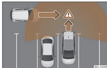
Billede 147 Skematisk billede af udkørselsassistenten: overvåget område for bil, der kører ud fra parkeringsbås
