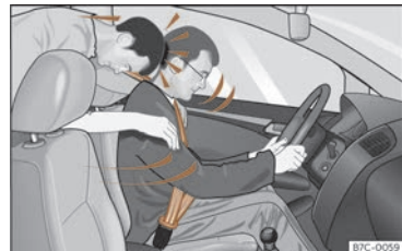
Billede 19 En bagsædepassager, der ikke har sikkerhedssele på, bliver kastet fremad og ind i den fastspændte fører.
