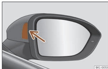
Billede 130 Kontrollampe til vognbaneskiftassistenten
