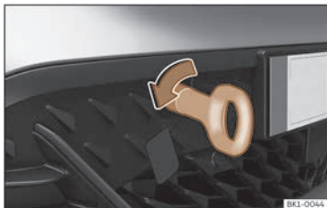
Billede 178 Højre side af den forreste stødfanger: slæbeøje, der er skruet i
