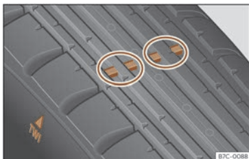
Billede 190 Dækprofil: slidindikatorer
