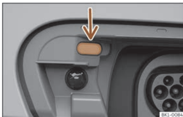
Billede 12 Bag batteriladeklappen: opladningsindikator
