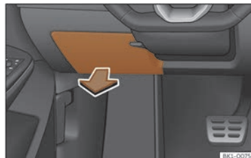
Billede 41 Instrumentpanelet i førersiden: afdækning på sikringsboks
