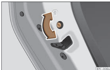
Billede 15 Børnesikring i venstre dør
