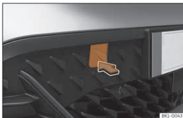
Billede 44 I den forreste stødfangerskab i højreside: fjernelse af afdækning
