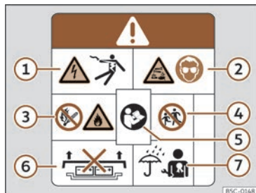
Billede 51 Advarselsskilt på højvoltsbatteri
