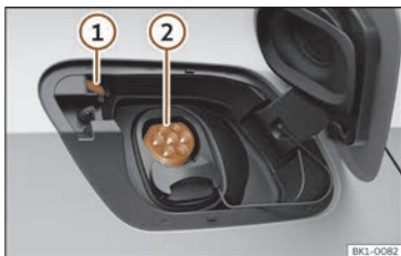
Billede 9 Bag batteriladeklappen bagest i højre side: ladestikdåse
