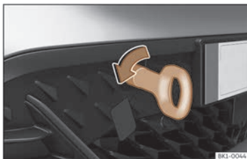
Billede 45 I den forreste stødfangerskab i højreside: iskrutning af slæbeøjje
