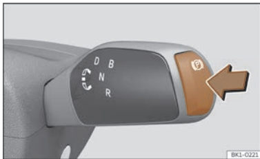
Billede 36 På gearvælgeren: knap til elektronisk parkeringsbremse
