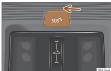
Billede 38 I tagkonsollen: knap til nødopkaldsfunktionen eCall (bag afdækningen til knappen) og kontrollampe (pil)
