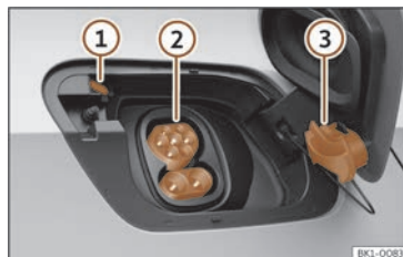
Billede 11 Bag batteriladeklappen bagest i højre side: ladestikdåse
