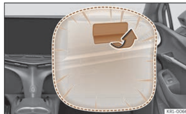
Billede 25 Forsædepassagerens frontairbag i instrumentpanelet
