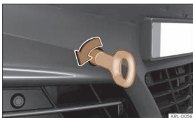
Billede 44 I den forreste stødfanger i højre side: iskruning af slæbeøje
