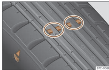
Billede 53 Dækprofil: slidindikatorer
