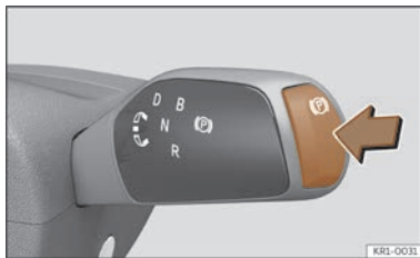
Billede 35 På gearvælgeren: kontakt til elektronisk parkeringsbremse
