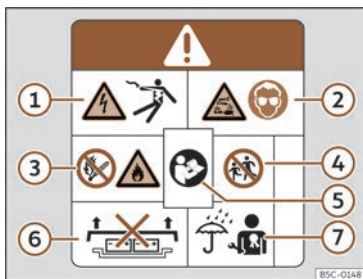
Billede 51 Advarselsskilt på højvoltsbatteri
