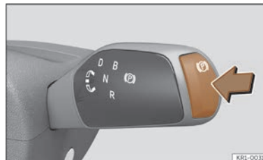
Billede 34 På gearvælgeren: kontakt til elektronisk parkeringsbremse
