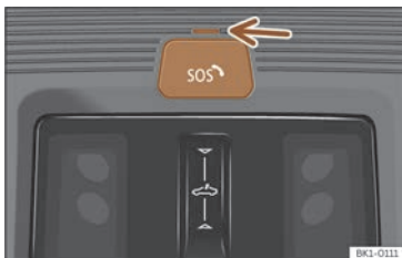
Billede 37 I tagkonsollen: knap til nødopkaldsfunktionen eCall (bag afdækningen til knappen) og kontrollampe (pil)
