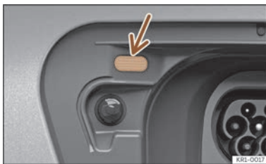
Billede 12 Bag batteriladeklappen: opladningsindikator
