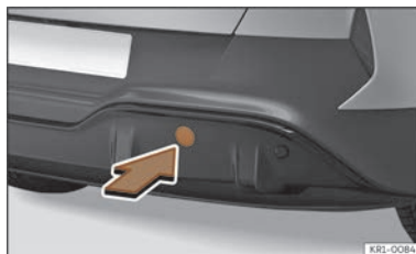
Billede 45 I højre side af den bageste stødfanger: fjernelse af afdækning
