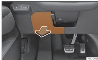
Billede 40 Instrumentpanelet i førersiden: afdækning på sikringsboks
