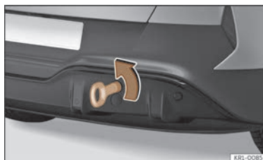
Billede 46 I højre side af den bageste stødfanger: slæbeøje, der er skruet i
