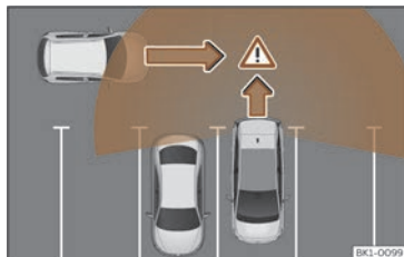
Billede 151 Skematisk billede af udkørselsassistenten: overvåget område for bil, der kører ud fra parkeringsbås
