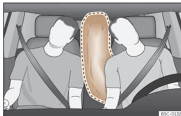
Billede 30 Centerairbag, der er foldet helt ud (udløsningsområde)
