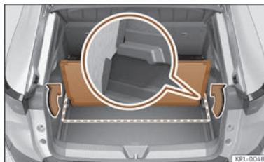
Billede 169 | bagagerummet: fastgørelse af ekstra bagagerumsbund
