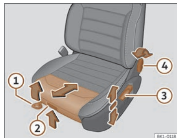
Billede 84 Forsæder: manuel sædeindstilling
