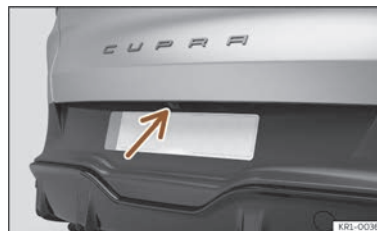
Billede 114 I den bageste stødfanger: placering af bakkamera
