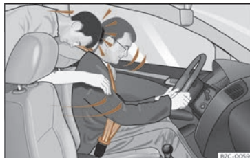
Billede 20 En bagsædepassager, der ikke har sikkerhedssele på, bliver kastet fremad og ind i den fastspændte fører.
