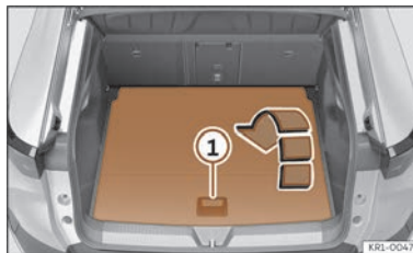
Billede 168 | bagagerummet: åbning af ekstra bagagerumsbund
