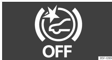
Billede 127 I kombiinstrumentets display: visning af deaktiveret Front Assist
