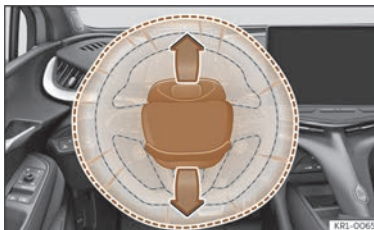
Billede 25 Førerens frontairbag er placeret i rattet.
