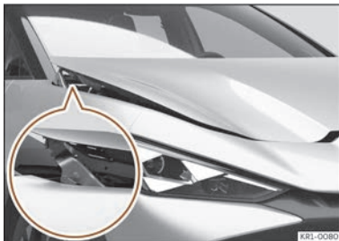
Billede 46 Aktiv frontklap hævet
