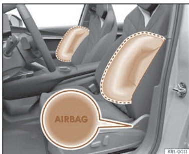
Billede 31 Sideairbag i fører- og passagersæde
