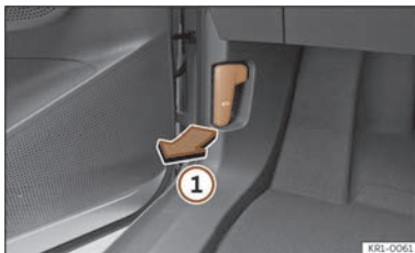
Billede 194 Udløserarm i fodrummet i førersiden
