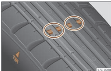
Billede 201 Dækprofil: slidindikatorer
