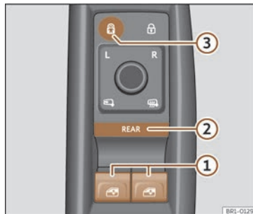
Billede 80 Udsnit af førerdøren: kontakter til betjening af elruder
