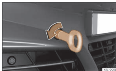
Billede 187 Højre side af den forreste stødfanger: slæbeøje, der er skruet i
