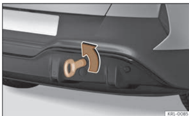
Billede 189 I højre side af den bageste stødfanger: slæbeøje, der er skruet i
