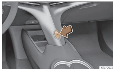
Billede 45 Midterkonsol: knap til havariblink
