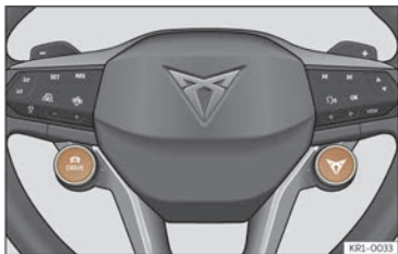
Billede 108 Multifunktionsrat: knapperne DRIVE og CUPRA til valg og skift af køreprofil
