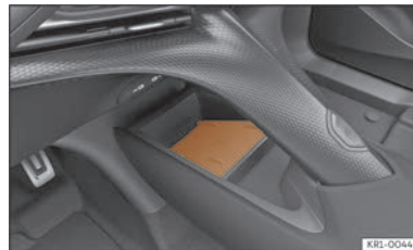
Billede 164 I midterkonsollen: holder til parring af mobiltelefon
