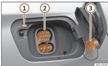
Billede 58 Bag batteriladeklappen bagest i højre side: ladestikdåse
