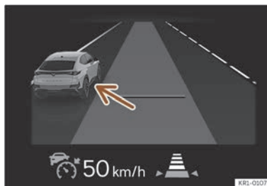
Billede 120 På kombiinstrumentets skærm: ACC aktiv, køretøj registreret i venstre side
