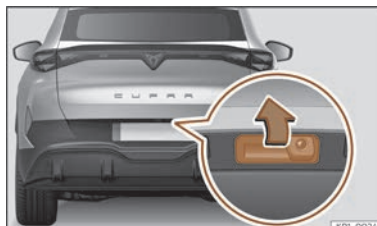
Billede 77 Bagklap: åbning udefra
