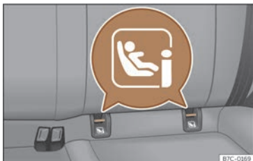
Billede 37 Bagsæde: placering for holdeøjer til ISOFIX eller i-Size
