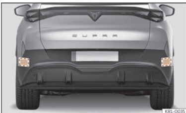
Billede 112 Område bag bilen: områder for radarsensorerne
