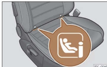
Billede 38 Bagsæde: placering for holdeøjer til i-Size
