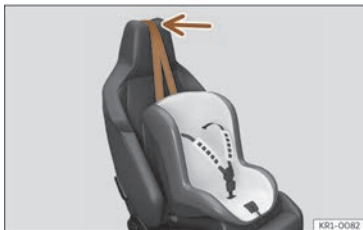
Billede 43 Passagersæde: indstilling og montering ved anvendelse af Top Tether-rem
