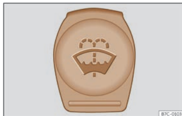
Billede 199 I frontrummet: blåt dæksel på sprinklervæskebeholderen
