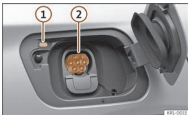
Billede 56 Bag batteriladeklappen bagest i højre side: ladestikdåse
