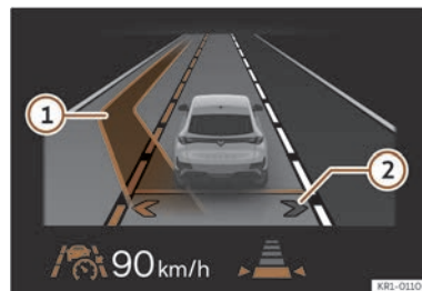
Billede 132 I kombiinstrumentets display: visning til assisteret vognbaneskift (skematisk visning)
